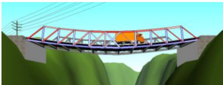
Les logiciels de conception assistée par ordinateur permettent des modélisations pour **simuler** l'utilisation de l'objet ainsi que son **comportement** dans certains cas. On peut alors **comparer** les **attentes** fixées par le **cahier des charges** et les **résultats** obtenus de la **simulation**. Les **écarts constatés** obligent de **corriger** l'objet modélisé avant sa fabrication.
